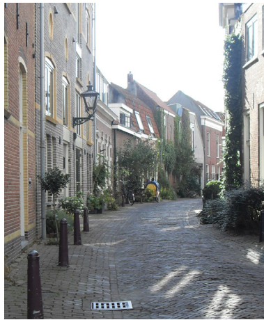
Fig. 101 Uso de candeeiros fixos na parede de edificações em arruamentos de espaço restritivo (Leiden, NL)
