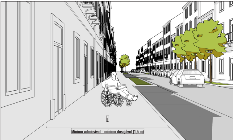
Fig. 51 Largura recomendável, mínima desejável e mínima admissível para acomodar os utilizadores com mobilidade reduzida
